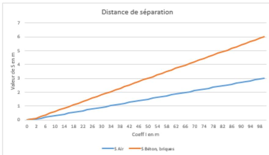
**NOTA:** La distance de séparation est la distance minimale pour laquelle il n'y a pas formation d'étincelle dangereuse entre un conducteur de descente écoulant le courant de foudre et une masse conductrice voisine liée la terre. Pour qu'il y ait isolement au sens des étincelles dangereuses, il faut que la distance d séparant le système de protection contre la foudre de l'élément conducteur considéré, soit supérieur à s.
