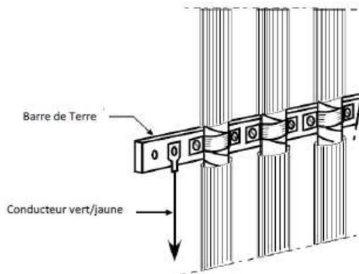
**Figure 15 : Mise à la terre de câble écrantés**
