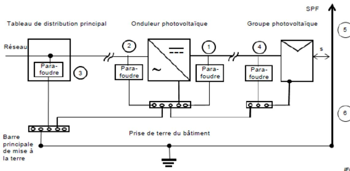
**Figure 10 : Installation de parafoudres dans le cas d'une installation photovoltaïque avec une installation extérieure du système de protection contre la foudre avec maintien de la distance de séparation**
