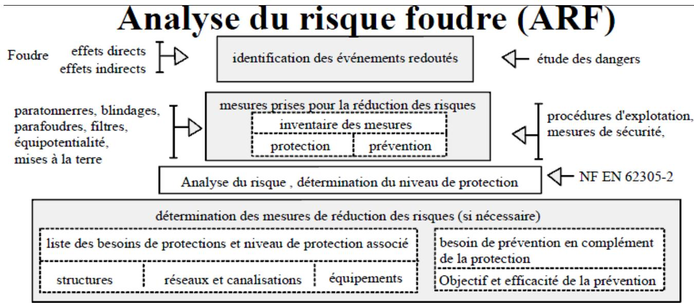
**Figure 2: Structure de l'Analyse de Risque Foudre**
