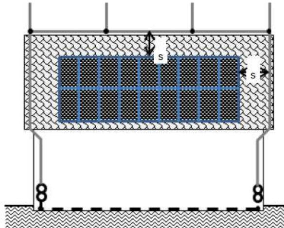
NOTE Il est recommandé de positionner le dispositif de capture du système de protection contre la foudre de manière à éviter un coup de foudre direct sur le groupe photovoltaïque et à réduire simultanément le plus possible les ombres produites sur les modules photovoltaïques.
