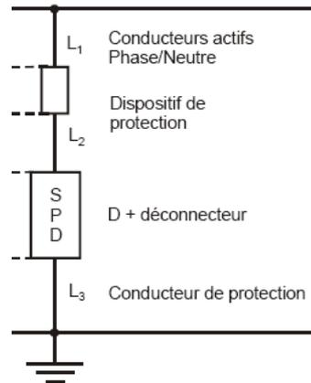
**Figure 13 : Principe de câblage d'un parafoudre**
