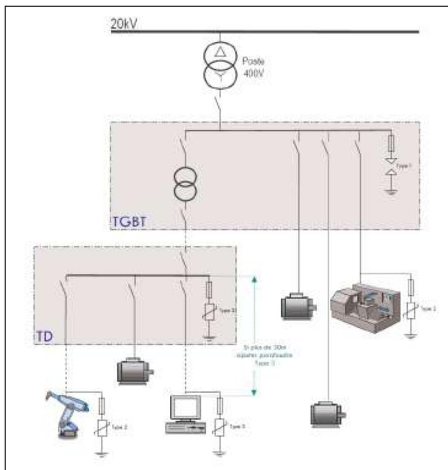
**Figure 8 : Principe de protection par parafoudres**
