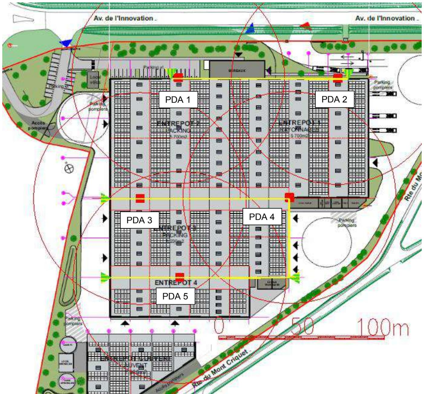
**Plan 1: Implantation des paratonnerres, conducteurs de descente et prises de terre**
