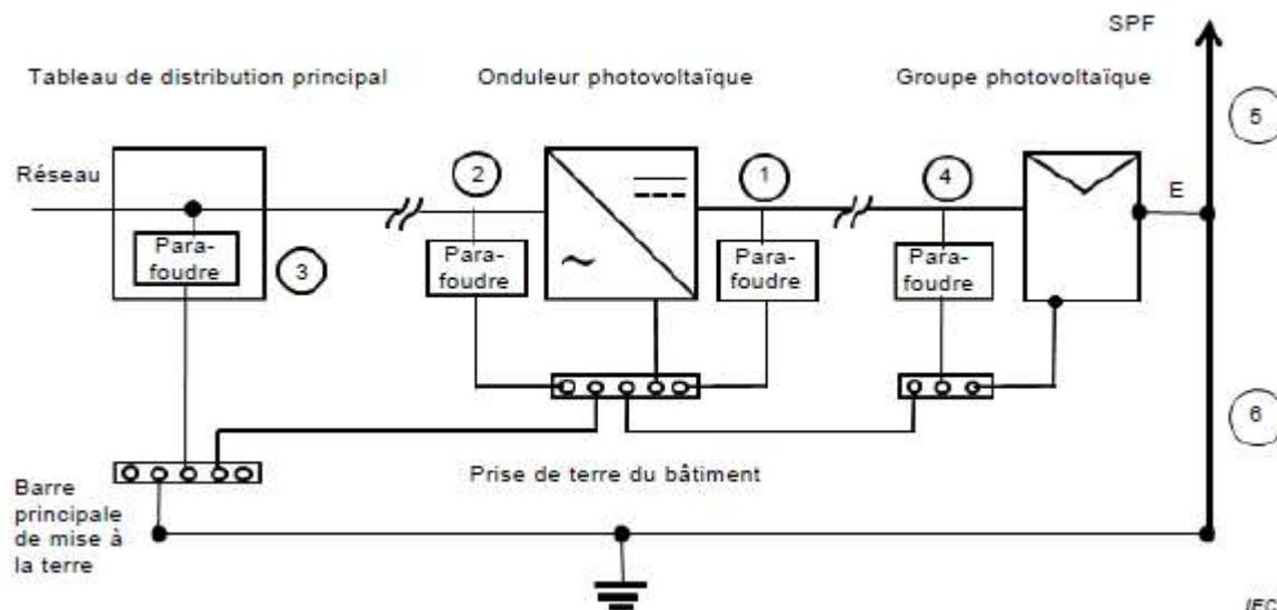
**Figure 11 : Installation de parafoudres dans le cas d'une installation photovoltaïque avec une installation extérieure du système de protection contre la foudre lorsque la distance de séparation (s) ne peut être maintenue**
