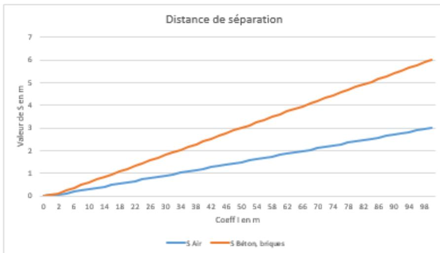
**NOTA:** La distance de séparation est la distance minimale pour laquelle il n'y a pas formation d'étincelle dangereuse entre un conducteur de descente évacuant le courant de foudre et une masse conductrice voisine liée la terre. Pour qu'il y ait isolement au sens des étincelles dangereuses, il faut que la distance d séparant le système de protection contre la foudre de l'élément conducteur considéré, soit supérieur à s.
